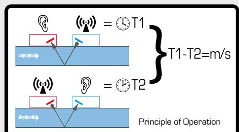
Не требуется врезки в трубопровод. Установка и измерение занимает считанные минуты, и нет необходимости перекрывать поток или опорожнять систему!
