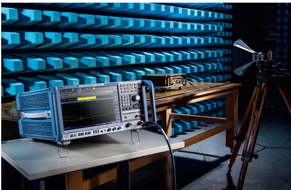
Измерение в безэховой экранированной камере в соответствии с MIL-STD-461, DO-160 и ГОСТ РВ 6601-002
