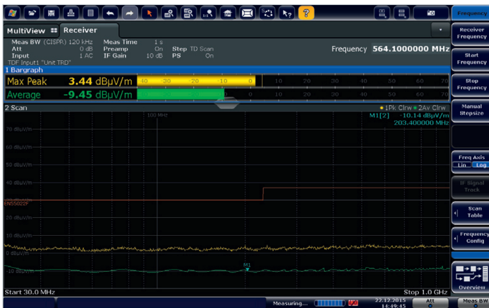
Собственный шум до 1 ГГц. Уровень собственного шума с предусилителем составляет примерно -8,5 дБмкВ/м.
