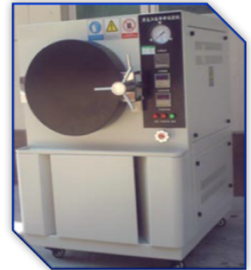
Машина РСТ для ускоренного старения
