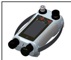
Рис. 2-1 Калибратор давления DPI611
