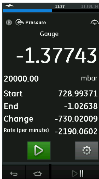
Рис. 2-25 Пример испытания на герметичность
