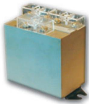
Используются в устройствах регулирования коэффициента мощности. В трансформаторах данного типа результирующий ток вторичной обмотки является средним значением векторной суммы первичных токов. По специальному заказу возможна поставка трансформаторов мощностью 15 ВА класса точности 0,5.
