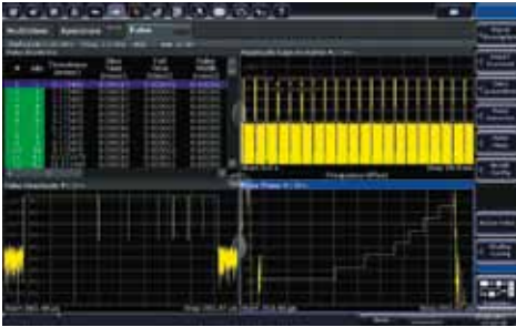
Оснащенный опцией измерения параметров импульсов R & S®FSW-K6, анализатор R & S®FSW-K6 позволяет получить характеристики импульсов одним касанием кнопки.
