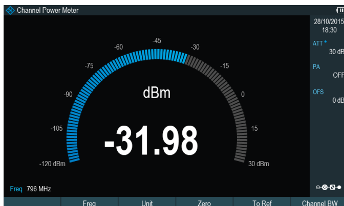
Окно встроенного измерителя мощности в канале (опция R&S®FPH-K19)
