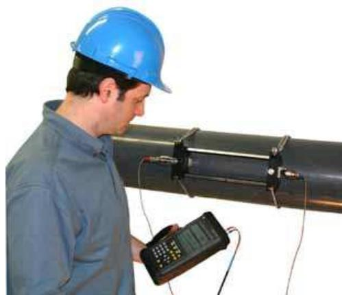
Для надежного крепления датчиков к трубопроводу существуют несколько видов арматуры крепления. В зависимости от типа используемых датчиков и диаметра трубопровода могут применяться арматуры крепления на лентах, на цепях, а так же магнитные
